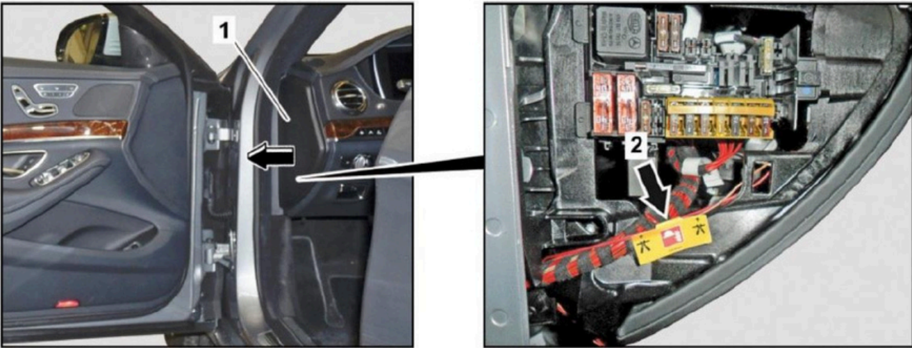
Retirar la cubierta (1) de la caja de fusibles / cortar el cable por el lugar marcado (2)
