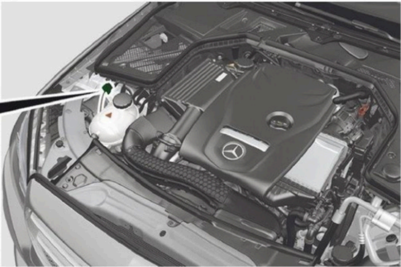
Dispositivo de desconexión de alto voltaje en el vano motor, Accionar el desbloqueo (1) / extraer el interruptor (2)
