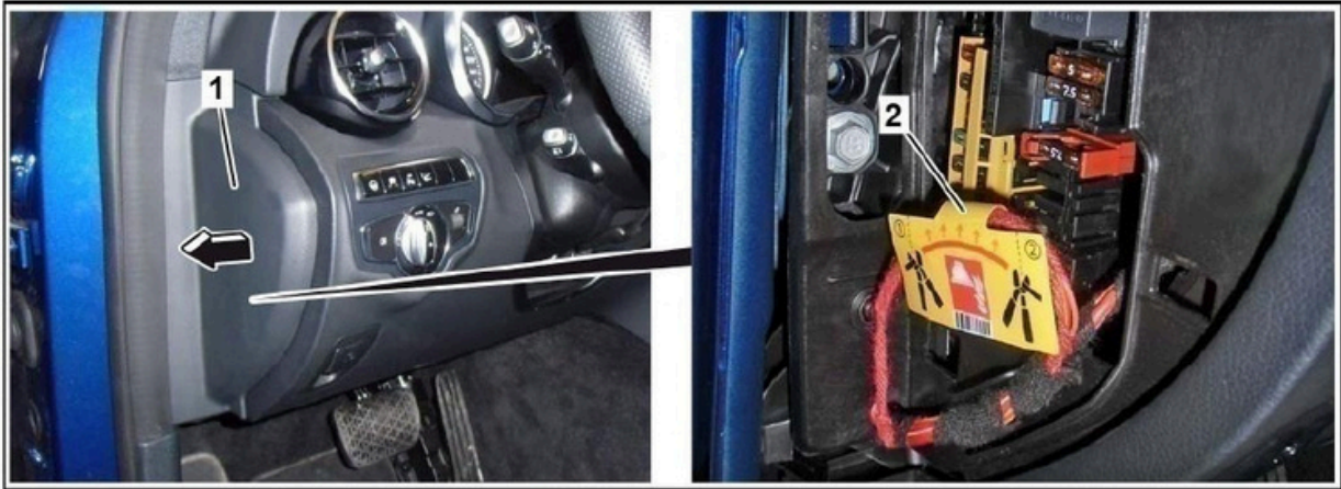
Retirar la cubierta (1) de la caja de fusibles / cortar el cable por el lugar marcado (2)
